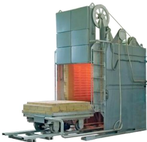
**Камерные электропечи сопротивления СНО, СНОТ, СНЗ** предназначены для термической обработки различных материалов в условиях окислительной (воздух) или защитной (нейтральный газ) среды при температуре до **1250 °С**.
