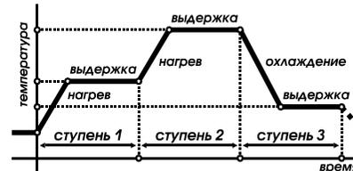
Ввод программы заключается в последовательном указании значений температуры выдержки, времени выдержки и скорости нагрева или охлаждения для каждой ступени вводимой программы. Для корректировки параметров ступени необходимо выполнить следующие действия:
