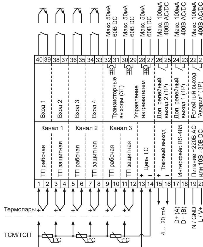
**При подключении термопары необходимо строго соблюдать полярность.**
