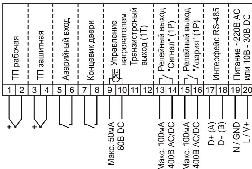
**При подключении термопары необходимо строго соблюдать полярность.**
